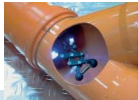
Die Kamera, hier an einer ferngesteuerten Schere, liefert Bilder aus dem Untergrund.
