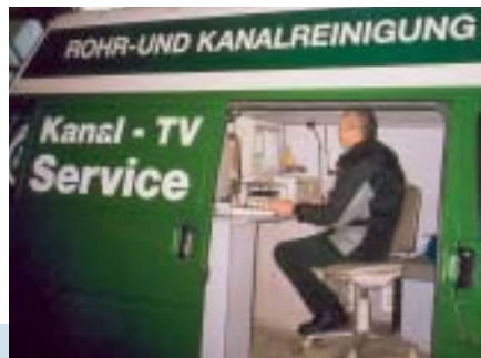
Der Prüfer sieht dann auf dem Monitor, wo Gefahr droht und wo saniert werden muss.
