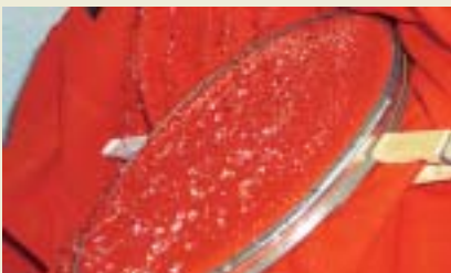
Gut imprägniert: Regen perlt ab. Rechts muss nachimprägniert werden.
