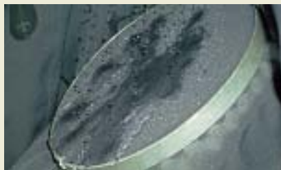
Gut imprägniert: Regen perlt ab. Rechts muss nachimprägniert werden.
