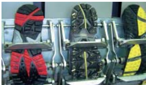
Härtetest im Labor: Links im Bild die Prüfung der Haltbarkeit von Stöcken. Unten wird die Dauerbiegefestigkeit der Schuhe in 30 000 Hüben getestet. Rechts eine typische Handschlaufe der Stöcke.
