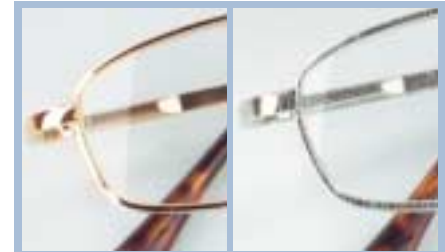
OHNE GOLDFARBE Fassung und Bügel von Star Optic wurden nach dem Schweißbelastungstest unansehnlich und rau.
