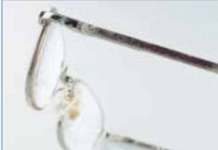
SCHUTZLACK Auf Metallteilen hielt er dem Schweißbelastungstest nicht immer stand.
