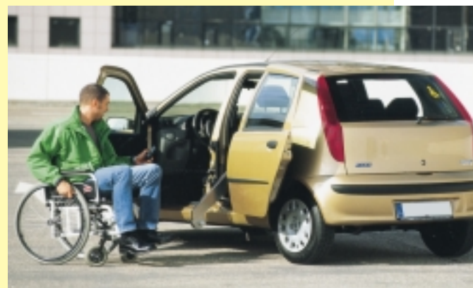
Ein Punto, ausgerüstet von Fiat-Autonomy mit Schiebetür und Rollstuhl-Verladelifter.
