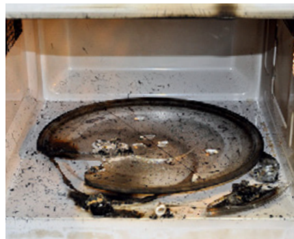
Kaputt, aber sicher. Aus keinem Gerät drang das Feuer nach außen.
