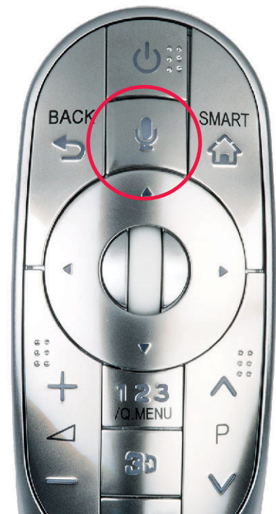
Hört aufs Wort. Nach Tastendruck werden Sprachbefehle ins Internet gesendet und in einen Steuerbefehl übersetzt.
