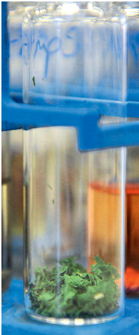
Im Glas. Die Lackschnipsel werden für die Schadstoffprüfung gesammelt.
