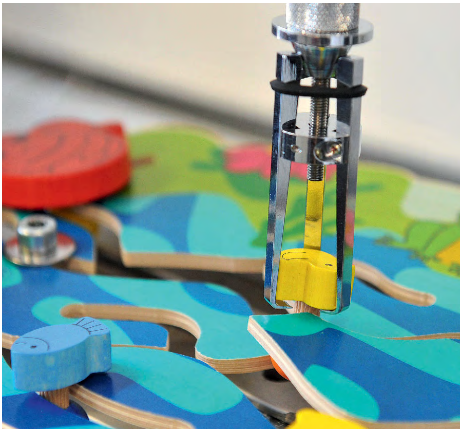
Zugprüfung. Der Greifer der Prüfmaschine zieht das Entchen zu leicht aus dem Sperrholzteich der Firma Hess.
