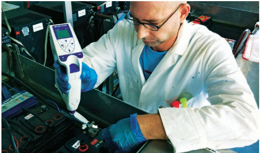
Laden und Entladen am laufenden Band. Beim Start-Stopp-Test wird die Batterie mit 3 600 Ladezyklen gestresst.
