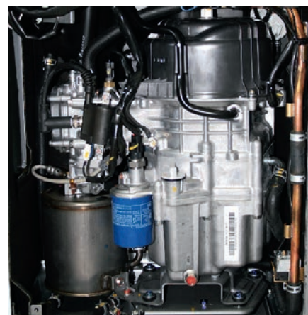
Ottomotor. Der gasbetriebene 1-Zylinder ist das Herz des Ecopower 1.0.
